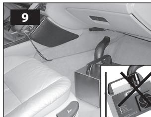
Поставить установку Aircomatic® II в горизонтальное положение на коврик в салоне автомобиля на пассажирском месте справа от водителя.
