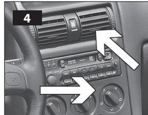
Направить поток воздуха в центр вентиляционного отверстия приборной доски
